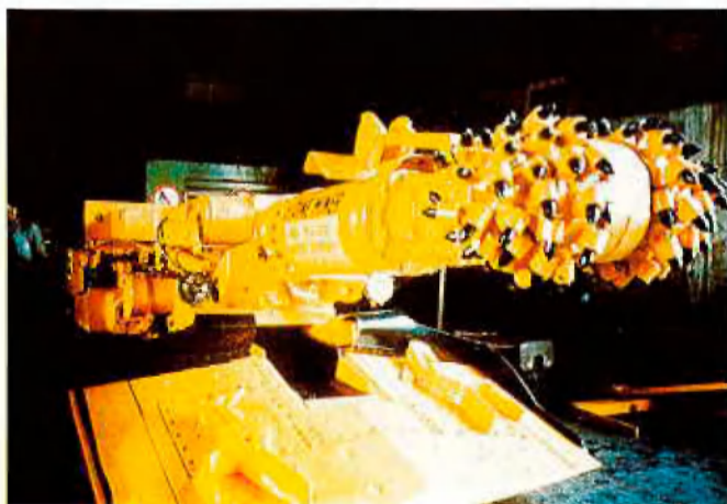
Abb. 1: AM 50 – Schrägarm mit Schrägwalze, Hummerscherenlader
