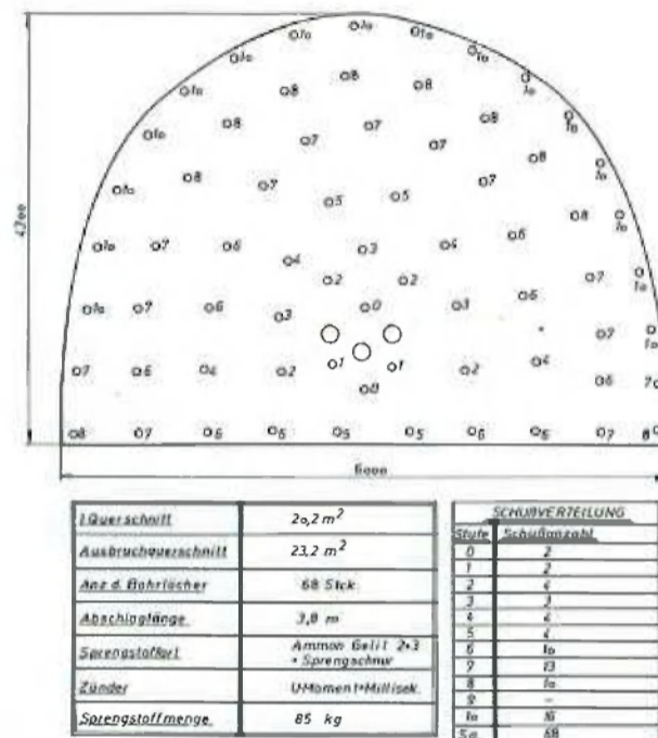
Bohr- und Sprengschema für Spreng- stufe: ms G auf Großbohrlöcher mit Sprengschnur
