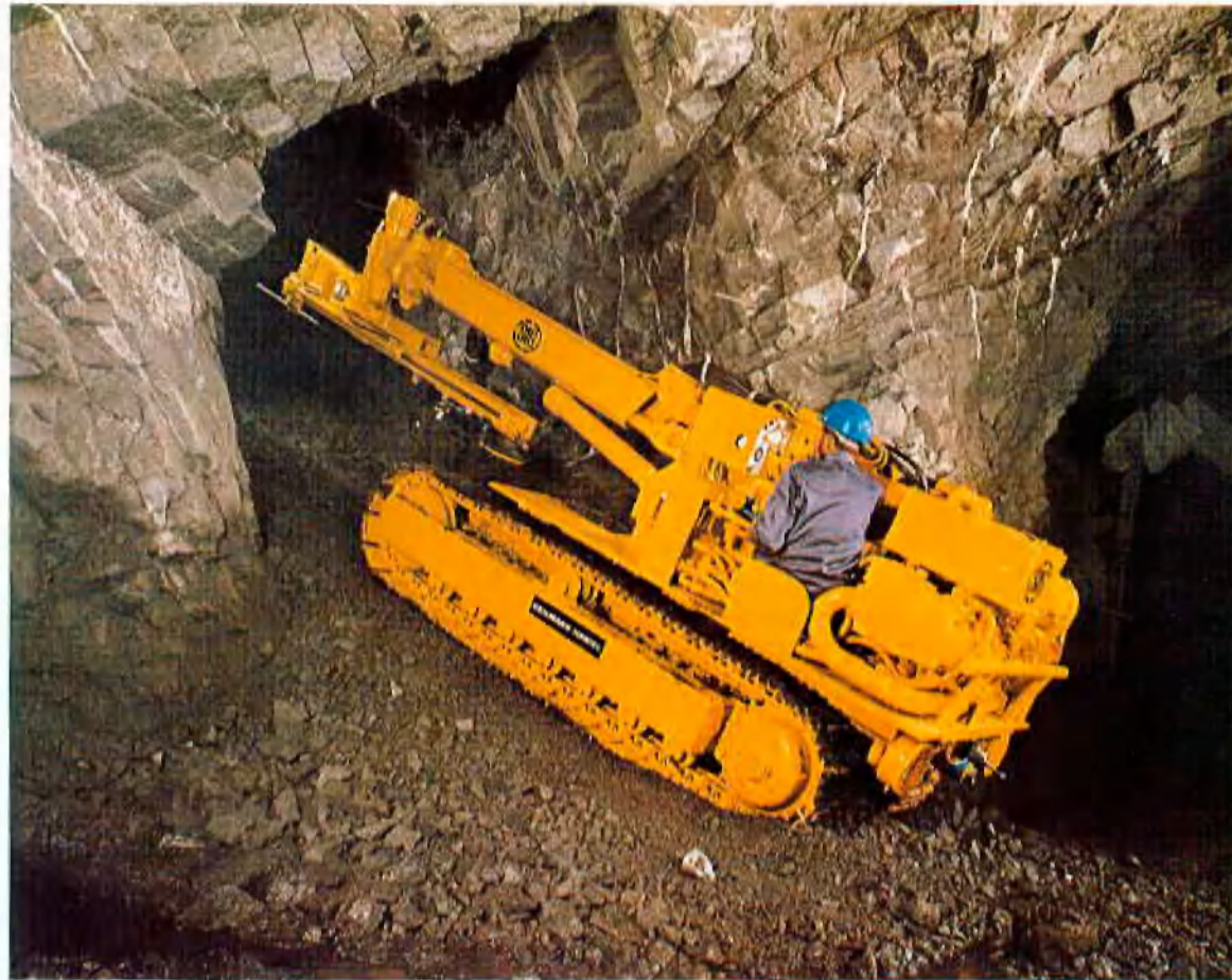
▲ Bohrwagen in Bergauffahrt mit eingefahrenem Hubtisch
