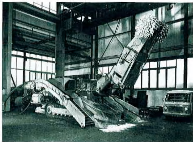
Abb. 1: Teilschnittmaschine WAV 200 in der Werkshalle
