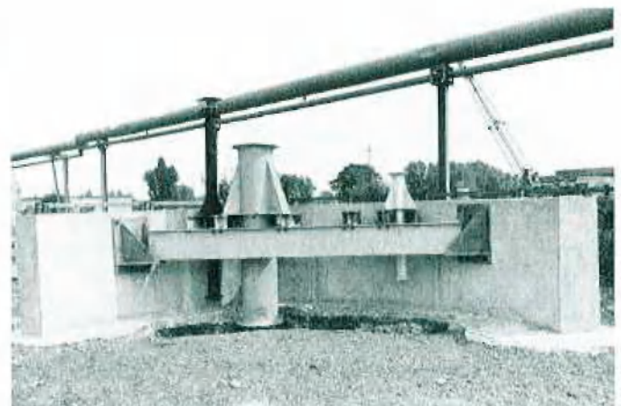
Abb. 2 Zwischenverlagerung für die 5 Rohrstränge, als Modell im Maßstab 1:1 übertage montiert.
