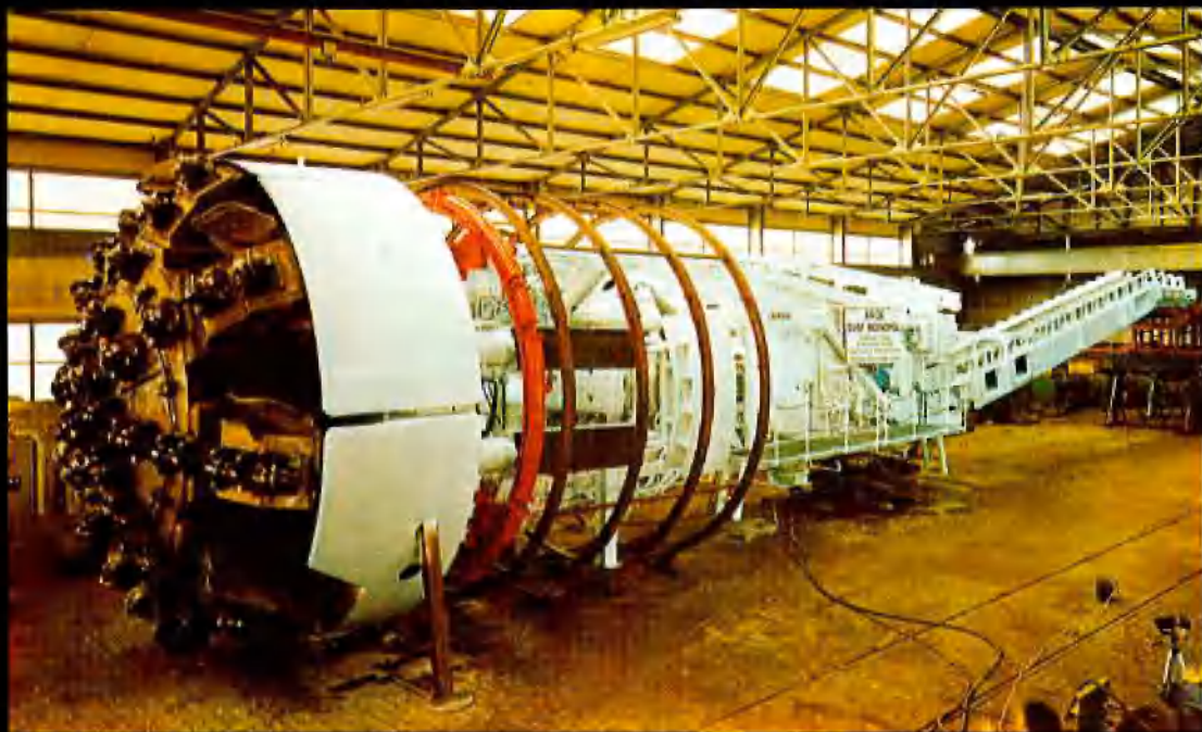
Die »Robbins«-Strecken- vortriebsmaschine nach dem Umbau für den neuen Einsatz
