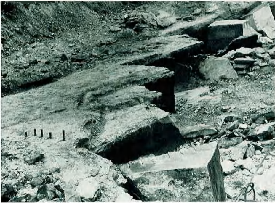
Der Abbau folgt den natürlichen Schwächezonen im Gestein, den Schichtflächen und den Kluftflächen. Das Bild zeigt zwei senkrecht aufeinanderstehende Kluftsysteme, die die Gewinnung von Blöcken ermöglichen
