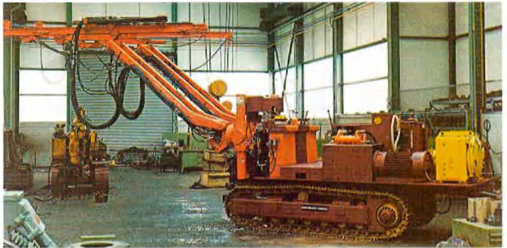
Abb. 1: Tamrock-Bohrwagen MR 600 H für eine Nutzbohrlänge von 2,7 m
