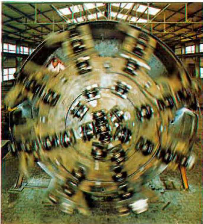
Abb. 4: Bohrkopf der Robbins-Maschine beim Probelauf in der Deilmann- Haniel-Werkstatt Kurl
