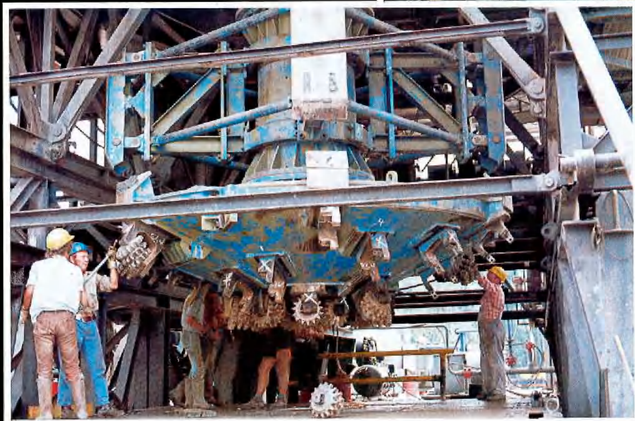
Der Bohrkopf wurde zur Überprüfung der 25 Drei-Ring-Zahnrollenmälzer regelmäßig gezogen
