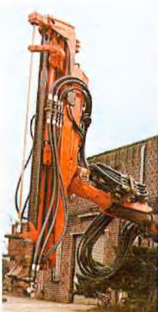
Abb. 3: Spreng- und Ankerlochbohrwagen, bestehend aus Deilmann-Haniel- ME-Raupe und Secoma-Bohrarm BVAN 1100 B mit Teleskopplatte CT 2,1-3,0 linke Bildseite: in Ankerstellung rechte Bildseite: Stellung für das Sprenglochbohren
