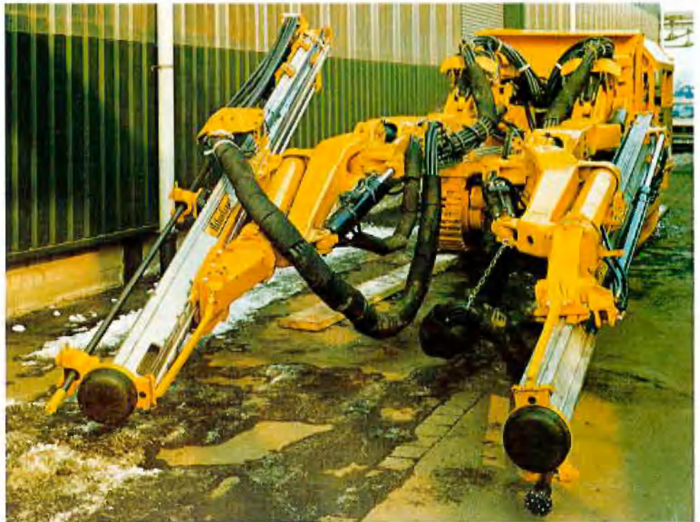
Abb. 3: Spreng- und Ankerlochbohrwagen, bestehend aus Deilmann-Haniel- ME-Raupe und Secoma-Bohrarm BVAN 1100 B mit Teleskopplatte CT 2,1-3,0 linke Bildseite: in Ankerstellung rechte Bildseite: Stellung für das Sprenglochbohren
