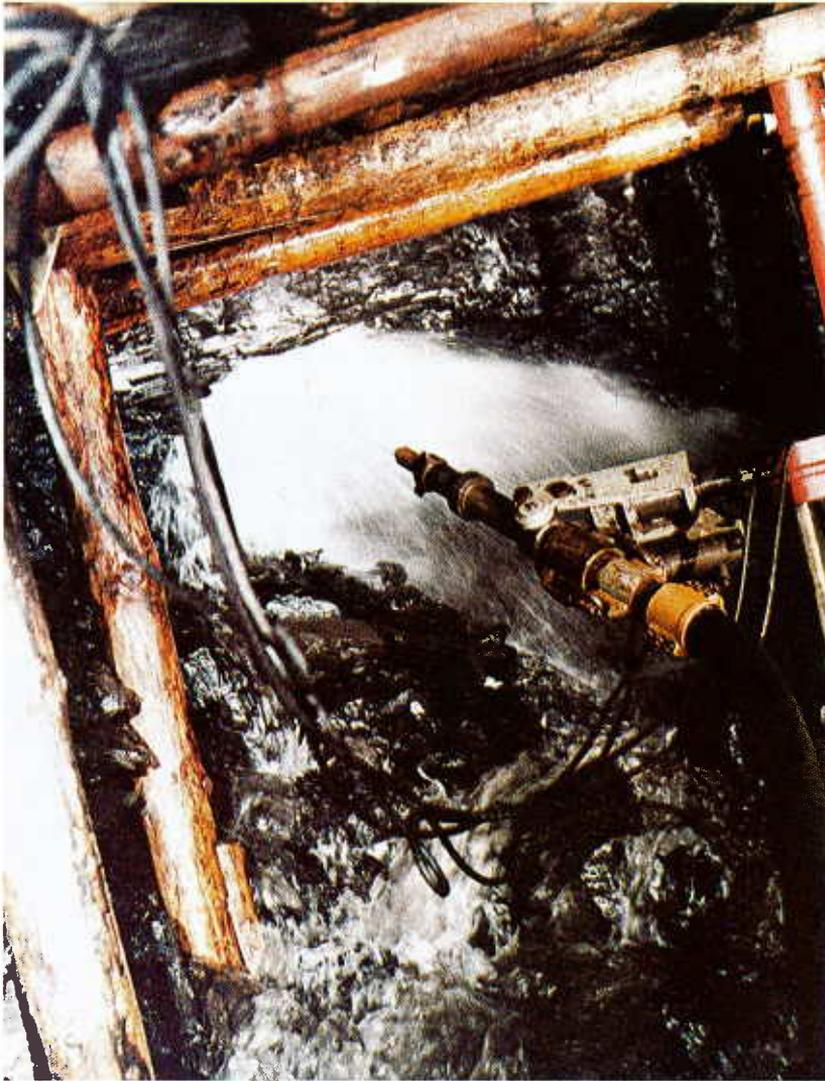
Abb. 1: Ferngesteuerter Hochdruck-Wasserwerfer bei der hydromechanischen Gewinnung der Kohle
