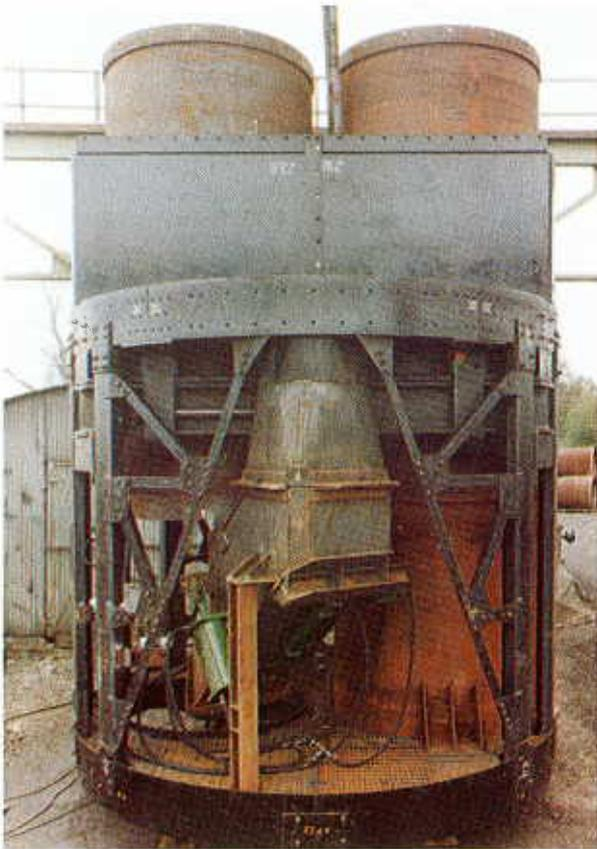
Abb.7: Füllbühne mit Bunkerladeschurre sowie Wetter- und Kübeldurchgangsrohren
