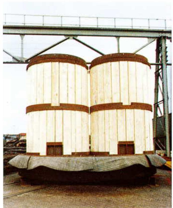
Die Stahlroste über den Bunkern haben Öffnungen von 400 mm x 500 mm. Die o.a. Abdichtung mit Gummilappen hat sich, im nachhinein betrachtet, nicht bewährt. Sie wurde gegen Stahlbleche, die mit Scharnieren am Bunkerkopf befestigt sind, ausgewechselt.
