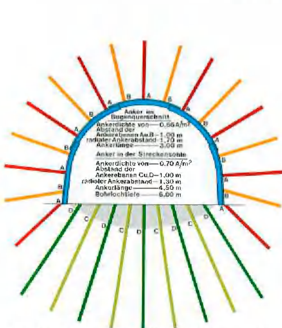
ANKERSCHEMA IN DEN ÜBERGANGSBAUEN VON TH 26,8 BIS TH 52,8 — 44 kg/m
