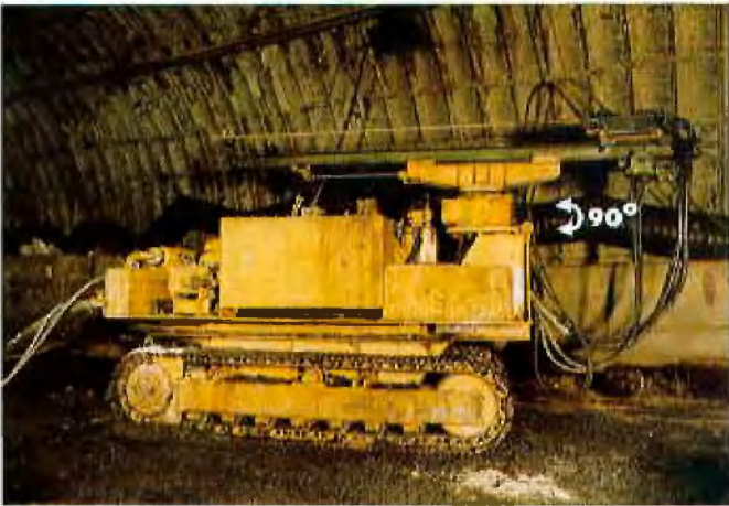
Abb. 2: Deilmann-Haniel Ankerbohrwagen in Parkstellung mit um 90° eingeklappter Bohrlafette
