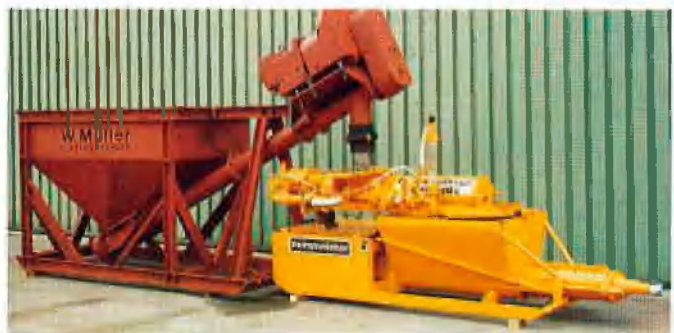
Abb. 7: Vorbunker mit Schneckenaustrag sowie Mörtel-Misch- und Spritzmaschine
