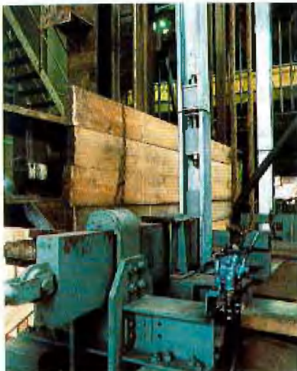
Abb. 13: Aufsetzen der nächsten Spurlatte
