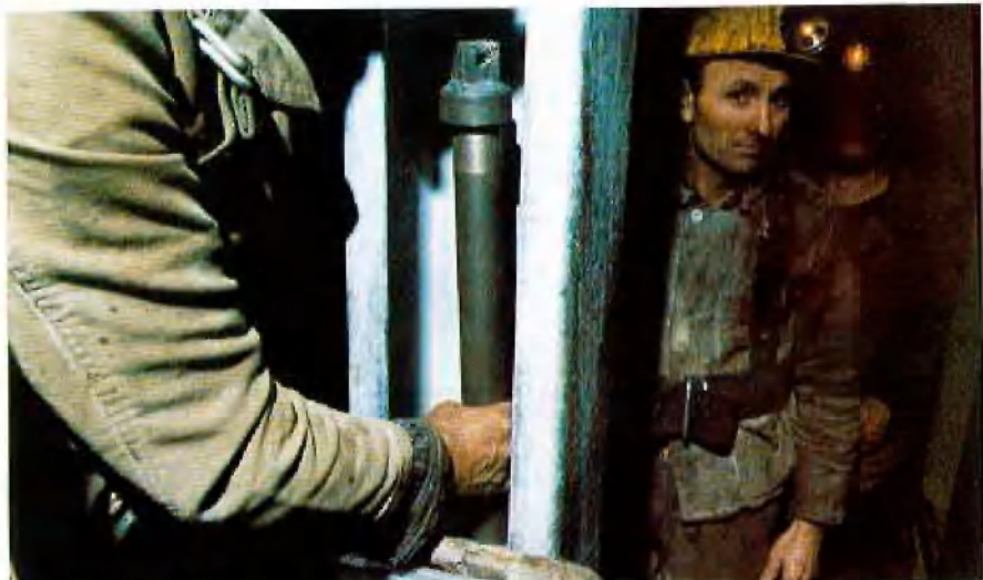
Abb. 16: Herausnehmen des Spezialverbindungsbolzens
