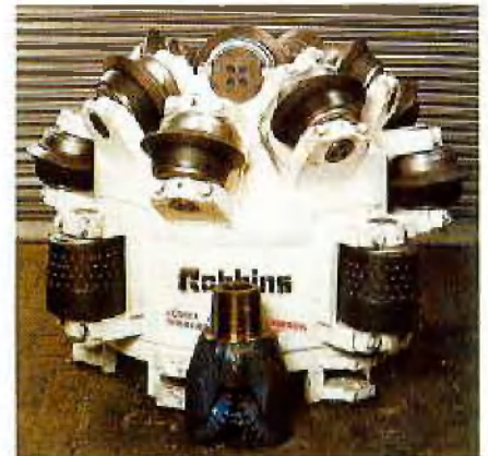
Abb. 4: Zielbohrmeißel und Erweiterungsbohrkopf
