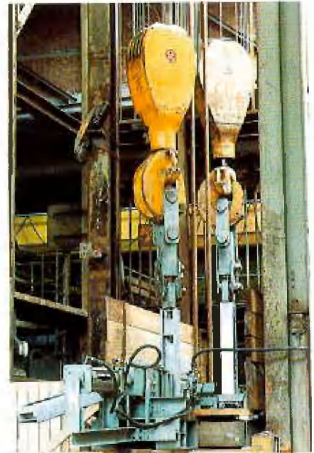
Abb. 15: Winden-Unterflaschen halten Spurlattenstränge
