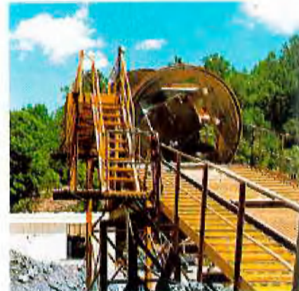
Kippeinrichtung für das Entleeren der Gleiswagen
