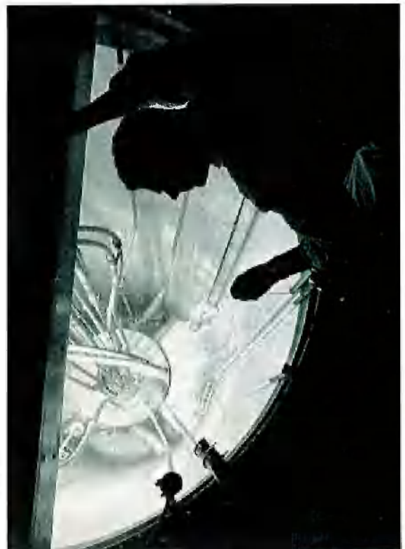
Blick auf den Kern eines von der GHH gebauten TRIGA-Forschungsreaktors
