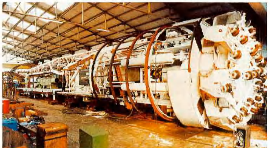
Abb. 2: Vormontage der gesamten Maschine in der Werkstatt Kurl
