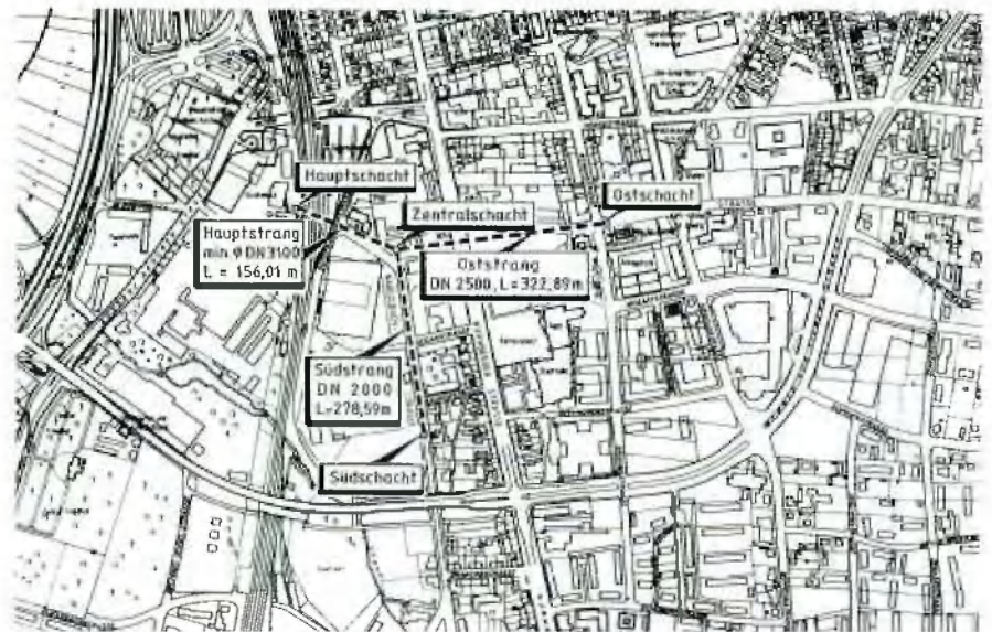
Abb. 1: Übersichtslageplan für die Fernwärmestollen
