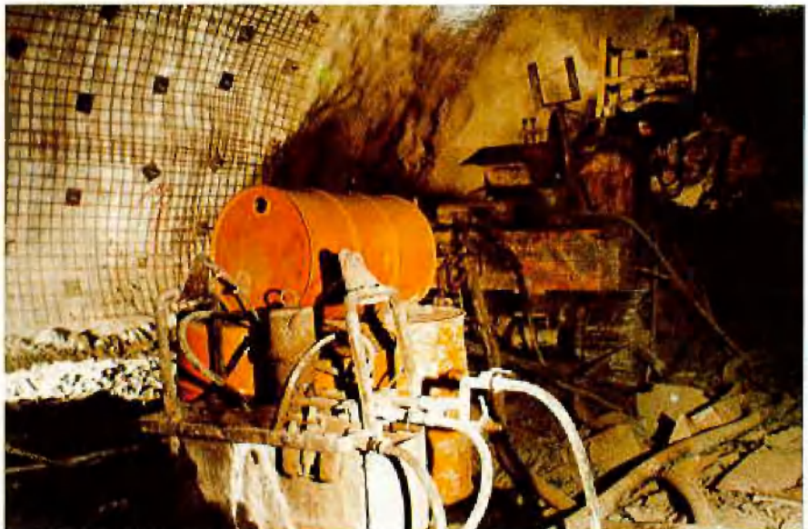
Abb. 8: Zumischgerät für Abbindebeschleuniger
