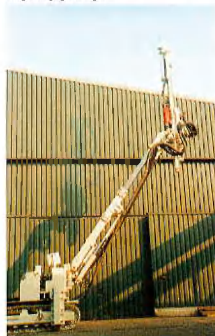
Ankerbohrwagen für 6-m-Anker mit Verlängerungsgestänge
