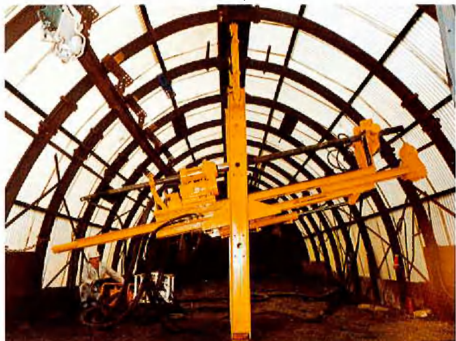
Kernbohrmaschine für die Entnahme von Kohleproben
