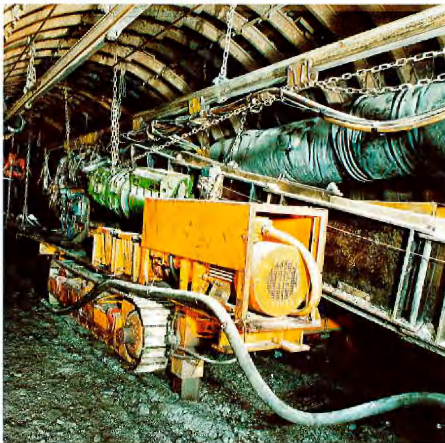
Abb. 2: Hydraulischer Raupenunterwagen mit eingebauter, in der Höhe verstellbarer Bandumkehre und aufmontiertem Kettenförderer
