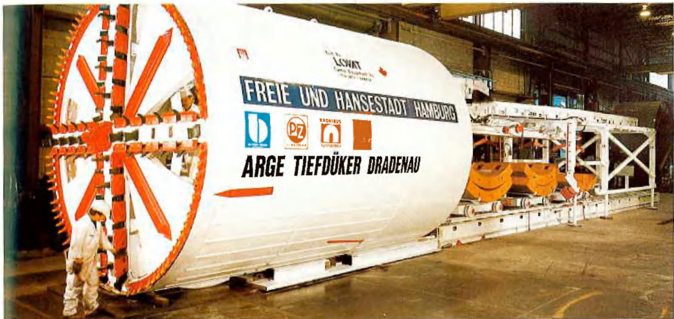
Abb. 3: LOVAT-Vortriebsschild mit Nachläufer in der Montagehalle
