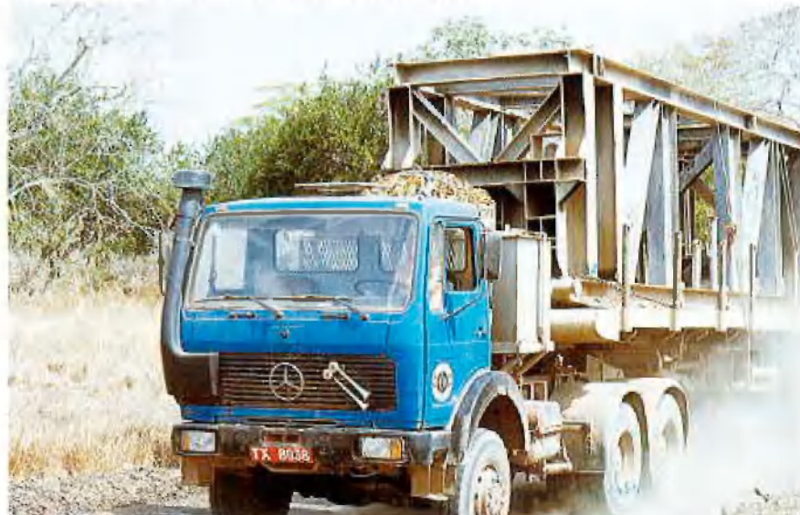
Der „move“, das Umsetzen des Bohrturms, beginnt
