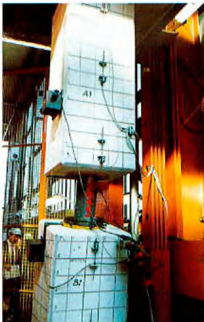
Abb. 11: Einbindeversuche unter der 6000-kN-Presse
