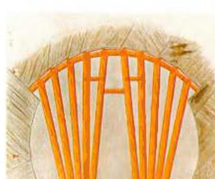
Abb. 2-5: Ausbruchphase, Verzimmerung und Gewölbeausmauerung am Sommerau Tunnel der Schwarzwaldbahn, Zeichnungen aus der Bauakte von 1871
