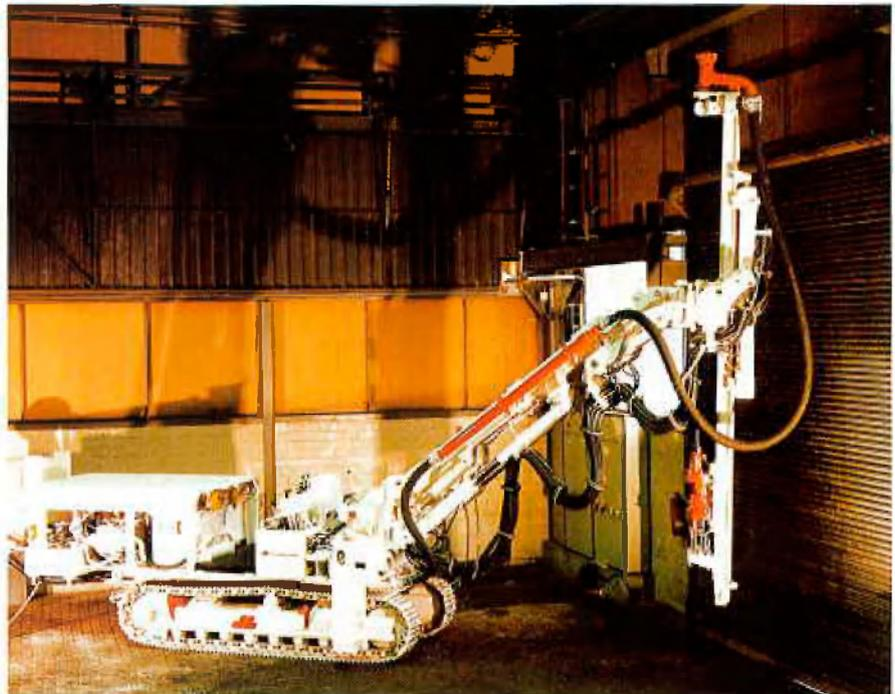
Abb. 1: Bohrwagen mit Entstaubungseinrichtung
