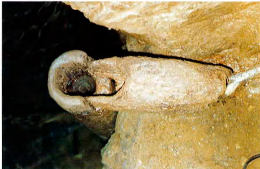
Abb. 4: Handbetriebene Kolbenpumpe unversehrt am Originalstandort (wenigstens 200 Jahre alt) - Das Bild zeigt die Ansicht von oben. Kolben und Kolbenstange fehlen. Zu sehen ist das im Abbau (unter Wasser noch Holzbühnen erkennbar) abwärts führende Pumpenrohr (5 m lang) und der seitlich nach rechts führende Auslauf.
