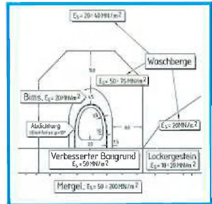
Abb. 1: Statisches System des Ausführungsentwurfs
