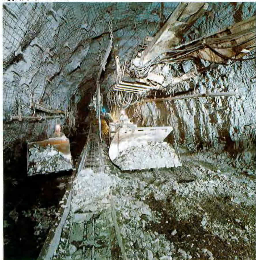
Abb. 3: Zwei DH-Lader beim Abfördern des Haufwerks
