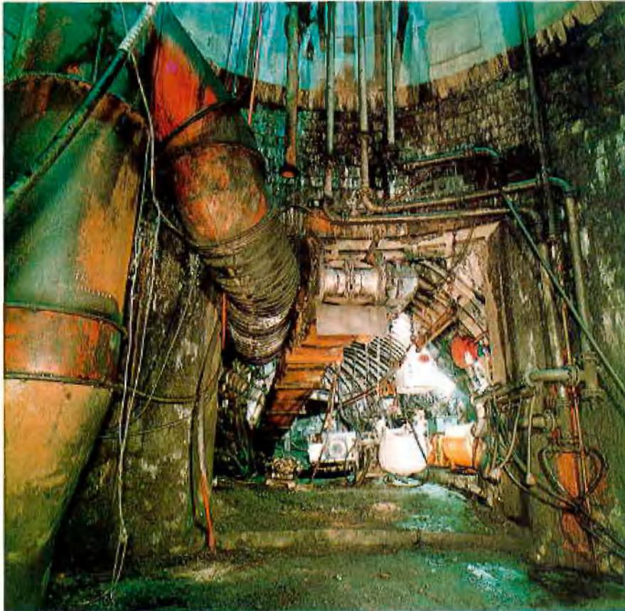
Abb. 8: Aussetzen der Flözstrecke Mausegatt
