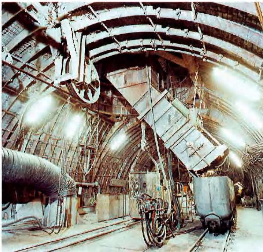
Kipp- und Beladeeinrichtung für Großraumwagen
