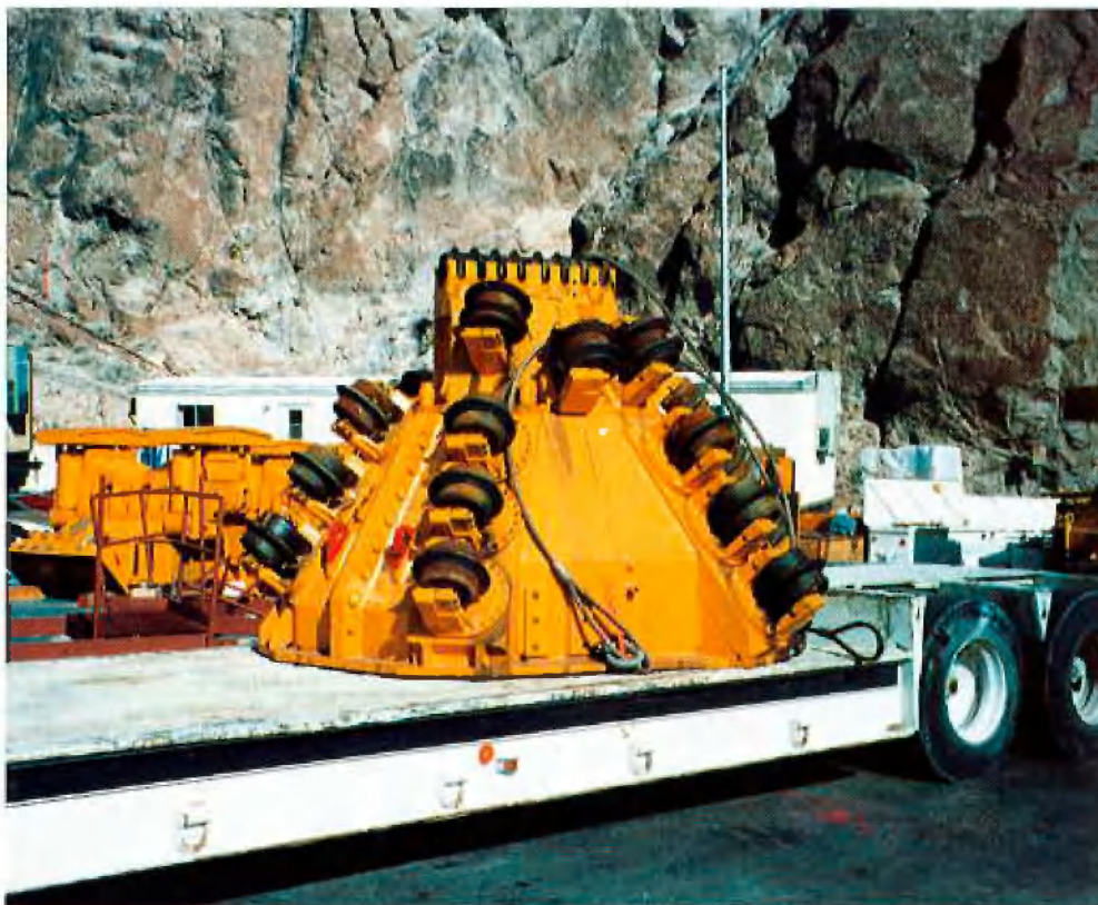
Anlieferung der Wirth-Gesenkbohrmaschine am Hoover-Damm
