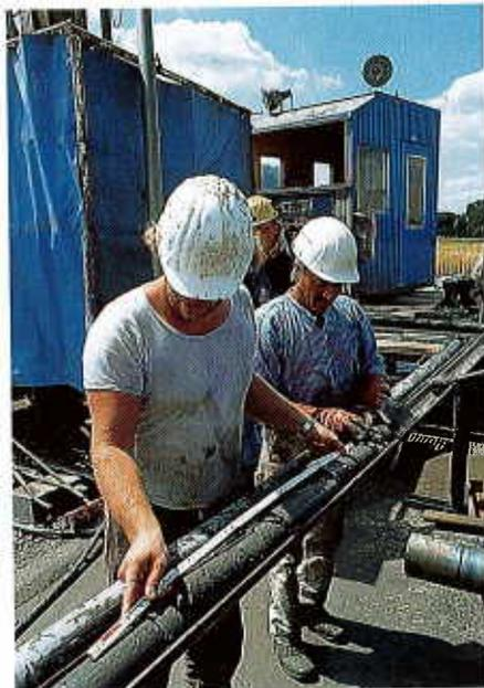
Vermessen eines Bohrkerns
