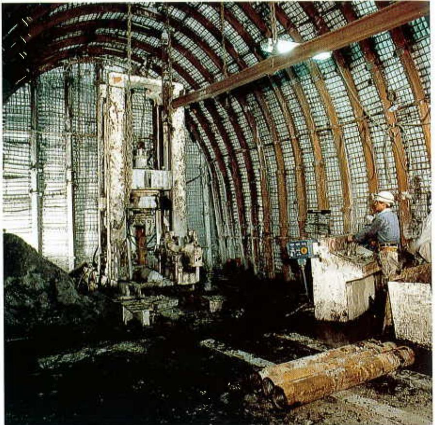
Raisebohrmaschine und Steuerstand
