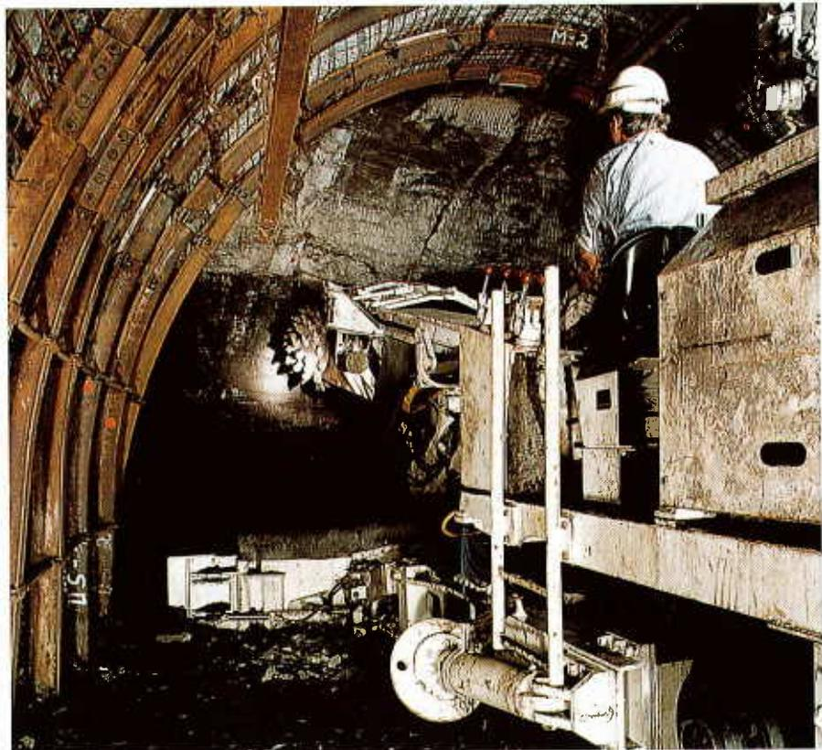
Streckenauffahrung mit einer Teilschnittmaschine
