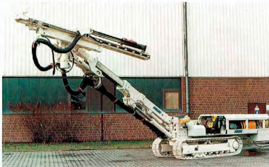
Einarmiger Bohrwagen Typ BTR-1
