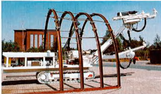
Demonstration der Bohrraum-Reichweite am Lader für Spanien
