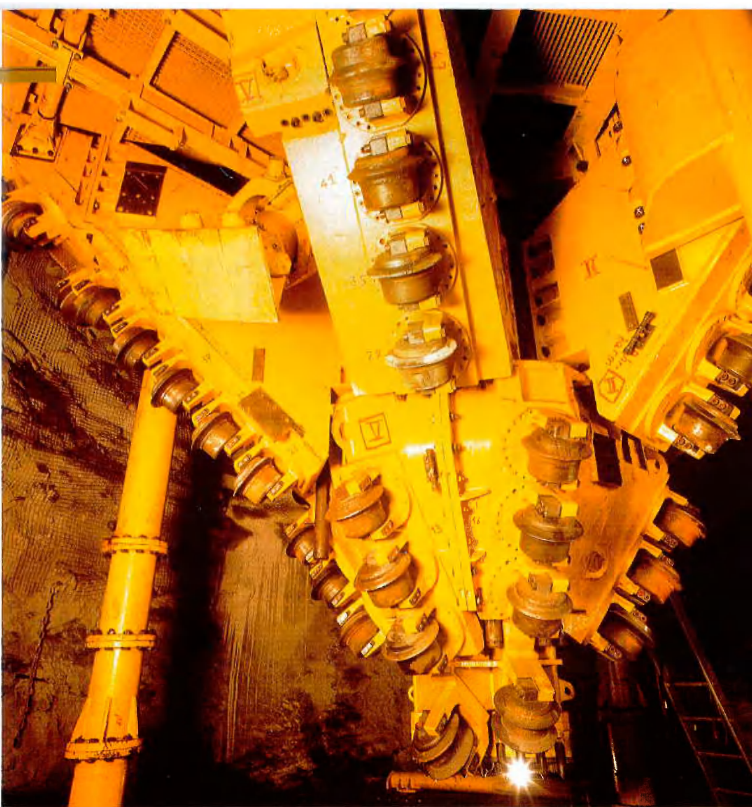
Fertig montierter Bohrkopf der SB VII
