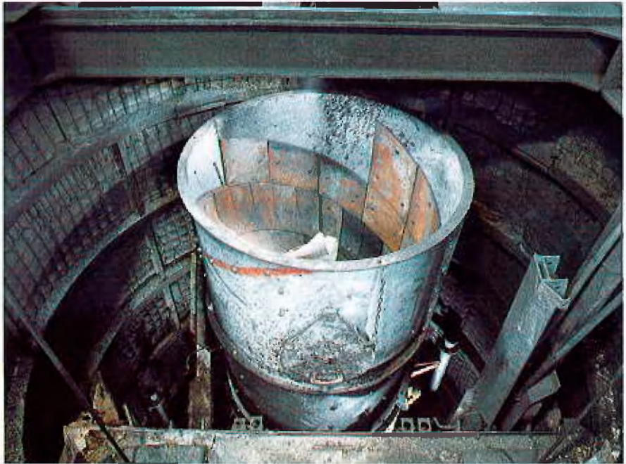
Förderverbindung mit eingebauter Wendel
