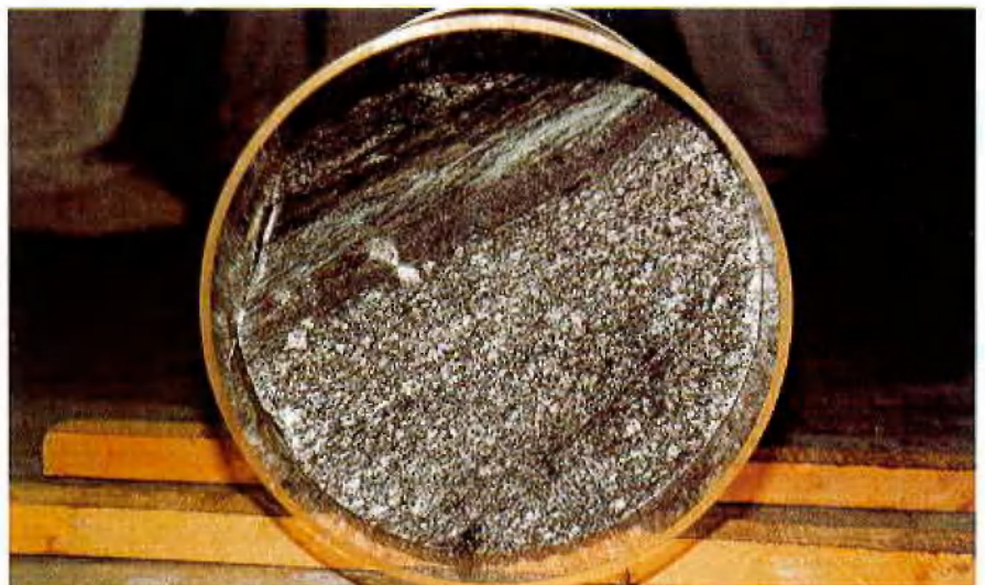
Bohrkern der Migrationsscherzone, Kerndurchmesser 288 mm, im Acrylglaszylinder
