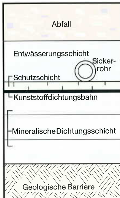
Schema einer Basisabdichtung
