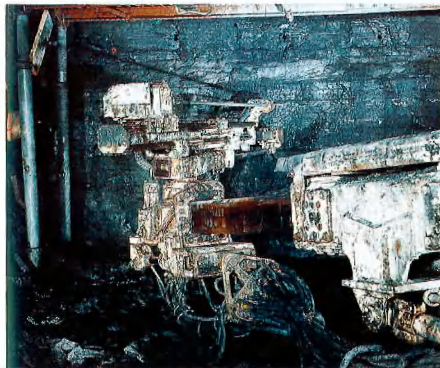
Bohren von Sprengbohrlöchern
