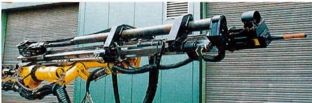
Bohrlafette mit Gestängemanipulator
