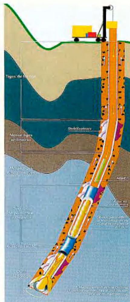
Prinzip des Richtbohrens
