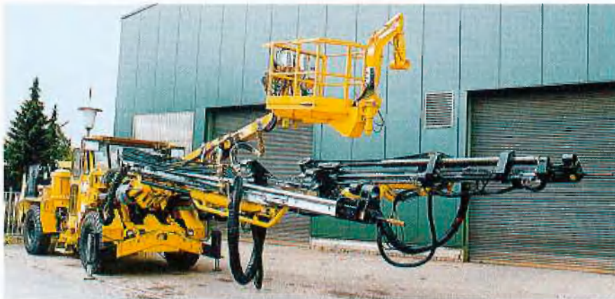
Tunnelbohrwagen, ausgerüstet für den Einbau von Rohrschirmen
