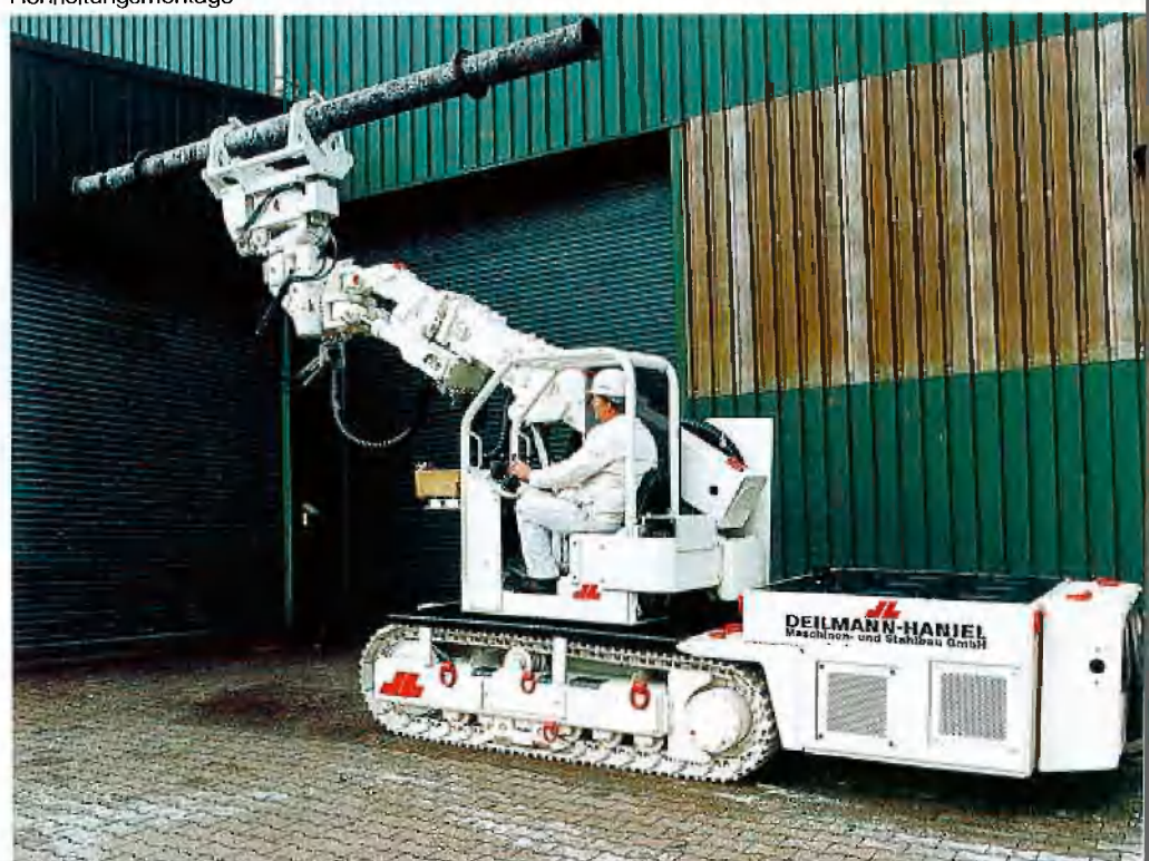
Ausbaumontage vor dem Heckteil des Manipulators Rohrleitungsmontage
