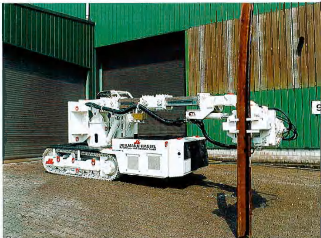
Ausbaumontage vor dem Heckteil des Manipulators Rohrleitungsmontage
